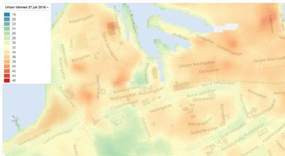
Figur 8. Bilden visar temperaturspridningen för 27 juli 2018 i centrala Malmö. I parkerna och nära vatten var temperaturen under 30 grader medan temperaturen i Gamla staden, Västra hamnen och i Nyhamnen nådde uppemot 42 grader. Källa: Malmö stad.
